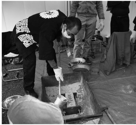
その場で溶かした亜鉛合金を流し込んだ
